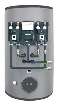
**Anbaugruppe** mit Isolationsbox für eine Heizgruppe inkl. 3-Wegventil mit Antrieb und Umwälzpumpe UPS 25-40, anschlussfertig für den Anbau an den Multispeicher.
